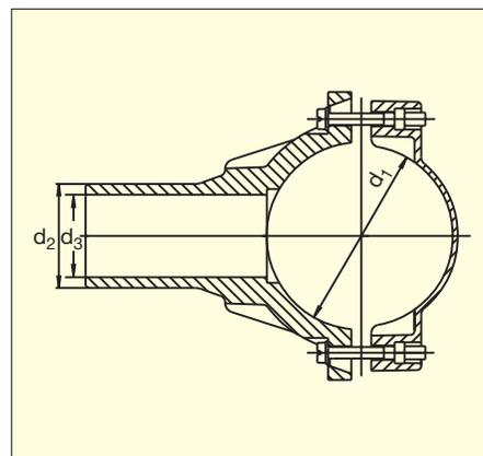
Рис. 8: Патрубки-накладки
