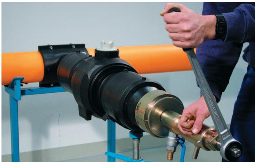
Рис. 4: Врезка через герметизирующее приспособление и шаровой кран
